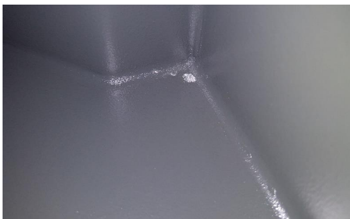
Rysunek 23. Niepowleczone powierzchnie
