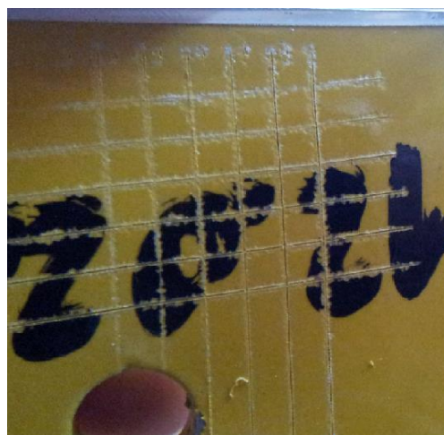
Rysunek 18. Skrzęca powłoka antygrafitti (efekt zbyt krótkiego utwardzania i/lub osiągnięcia niedostatecznej temperatury)
