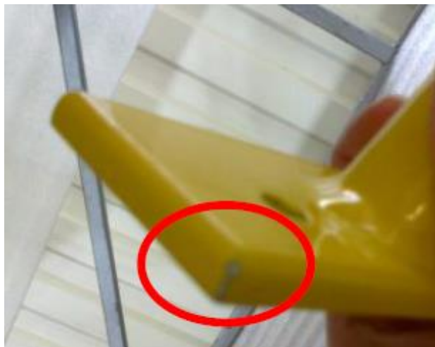
Rysunek 15. Mechaniczne uszkodzenie powłoki
