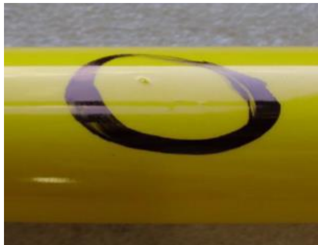
Rysunek 16. Wtrącenie ciała obcego
