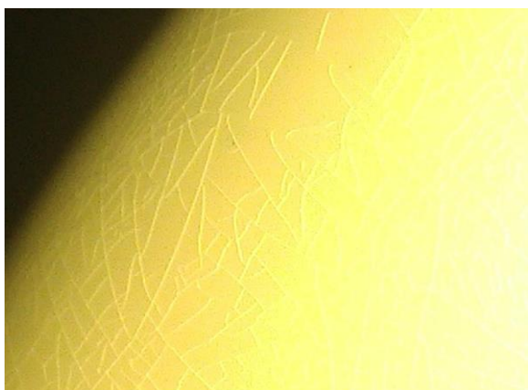
Rysunek 21. Defekt zwany „pajęczkiem”
