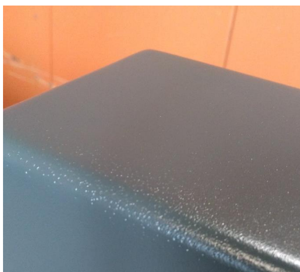
Rysunek 24. Za duża grubość powłok – zaburzenie struktury
