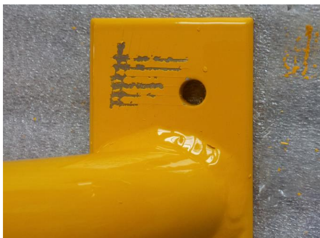
Rysunek 17. Niedostateczna przyczepność powłoki
